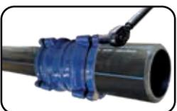
5 Una vez presentado el cople, apretar en forma secuencial los tornillos hasta un torque de 30 lbs/ft. Para fijar el anillo a la tubería de PEAD
